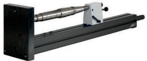
Anwendung als Rundlaufprüfgerät
